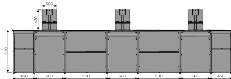
Основные узлы кассового стола (показана только часть однотипных компонентов)
