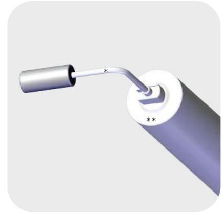
\* Кабель питания мотор-барабана (отд. заказ)
